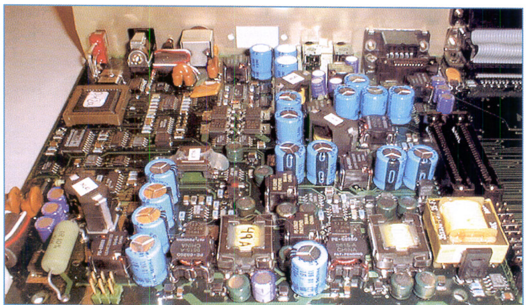
Bild 13: Blick auf eine Elektronik-Platine eines mit einem hochwertigen Frequenz-Analysator ausgestatteten Schallpegelmessers (environmental analyser) Typ 121 (Werkfoto Norsonic)
