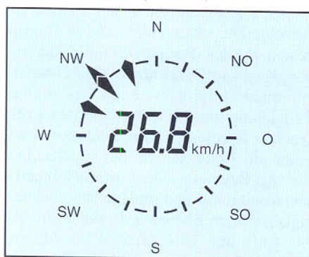
Bild 17: Hauptwindrichtung und Schwankungsbreite sowie Windgeschwindigkeit werden innerhalb einer stilisierten Windrose angezeigt.
